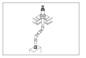
POWERED VERTICAL FLUE SYSTEM
